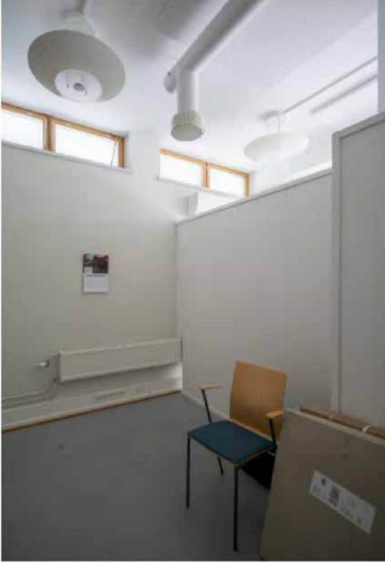
Vanhan piirustussalin pienin toimisto/tukitila jää vaatimattomaksi. Valoa tuovat päätyseinän ikkunat ja suuret ikkunat sermin takaa. Ilmanvaihto on tilassa näkyvillä koteloinnin sijaan.
